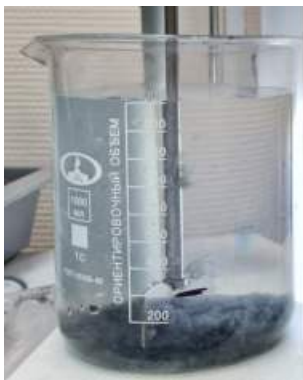
Рисунок 2 – Пример образования крупных хлопьев (флокул), которые формируют уплотнённый осадок
