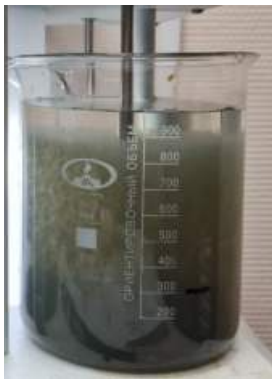
Рисунок 1 – Пример образования мелких, плохо оседающих хлопьев в процессе добавления коагулянта Аквалент® СА-А2-01
